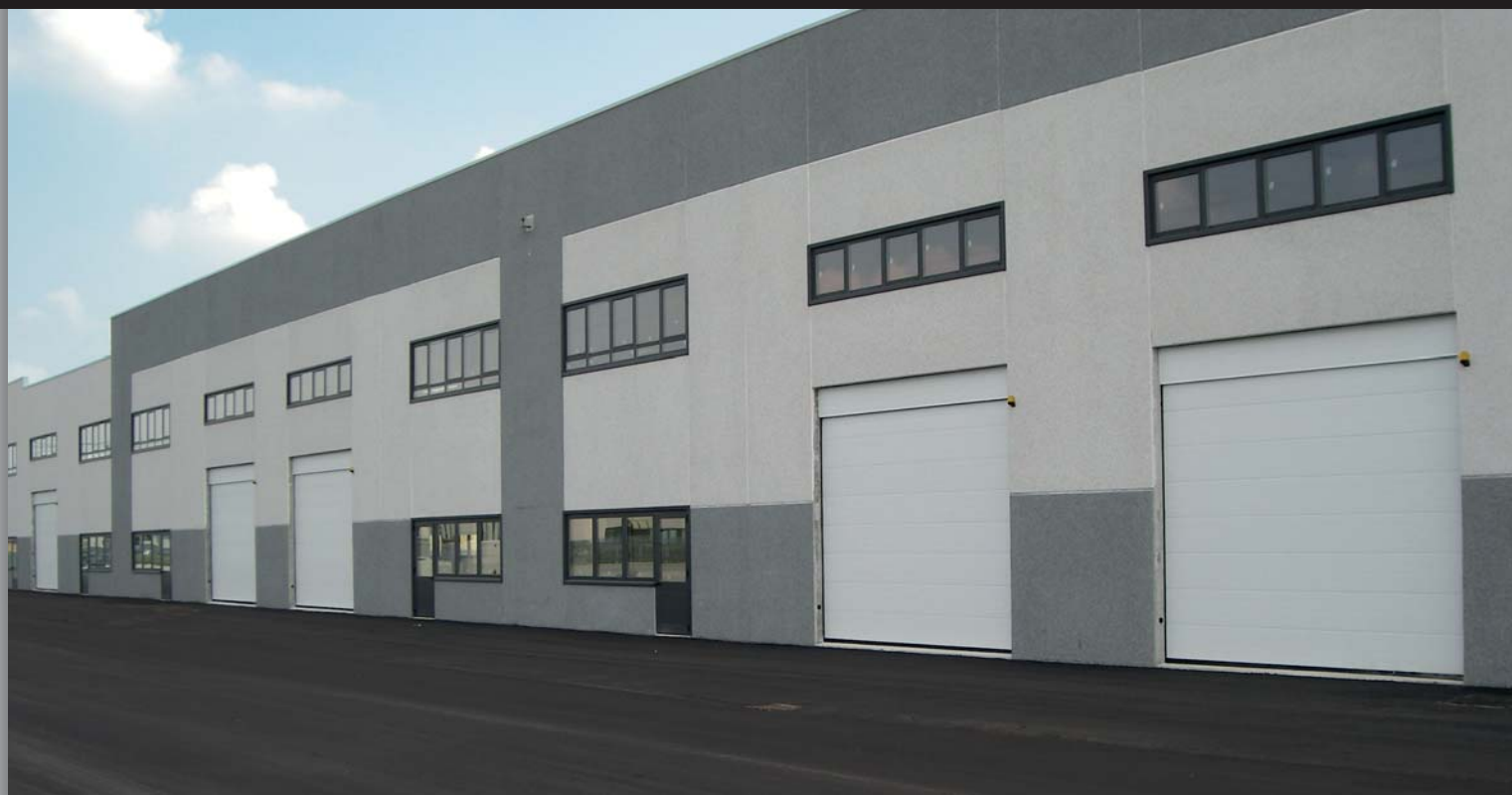
Portone sezionale RAL 9010 con veletta in pannello
