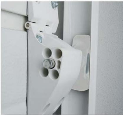
④ Nuova cerniera laterale brevettata con posizionamento rapido della ruota di scorrimento; scegliendo il foro più adatto tra i 5 presenti sul carrello, si ottiene un abbattimento notevole dei tempi di montaggio; la profondità minima impedisce che ci si possa inopportunamente "arrampicare"; previste nello standard le protezioni antischiacciamento delle dita su tutti i rulli di scorrimento.
