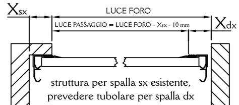
Xdx e Xsx : standard 100 mm, minimo 80mm; nel caso di spalle da creare con tubolari la versione da 100mm è in alluminio, quella da 80mm in ferro.
