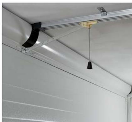
① Esclusivo carter copri-molle brevettato che garantisce estrema rapidità di montaggio e ottimi risultati estetici e funzionali; velocissimo da montare, diminuisce le necessità di intervento per la pulizia e la lubrificazione delle molle di torsione. Disponibile solo nello scorrimento WA.
