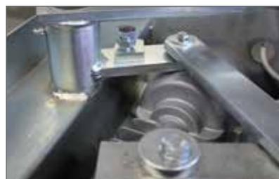
Finecorsa con regolazioni di alta precisione
